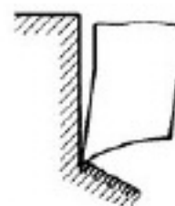
Fig. 37 Solution provisoire en cas de mortaisage sans dégagement d'outil
