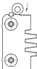
Par le réglage de la bague excentrique, il est possible de décaler la plaquette de 0,2 mm. Cela permettra d'ajuster le serrage de l'assemblage en fonction de la qualité de la colle et du type de bois usiné.
