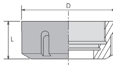
Écrou de serrage à roulement à billes
