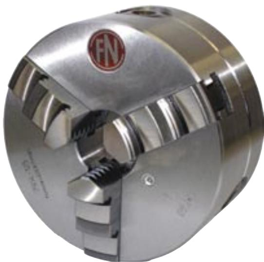
Les mâchoires de serrage s'ouvrent et se ferment, dans leur plage de serrage, de manière centrée et en continu, par le biais d'engrenages coniques (pignons) et de la spirale plane. Le corps du mandrin est en acier et est équipé d'un système de lubrification central. Les garnitures sur la spirale plane et les mâchoires de serrage ont été trempées. Les flancs de la spirale et du filetage des mâchoires de serrage ont été rectifiés des deux côtés.
