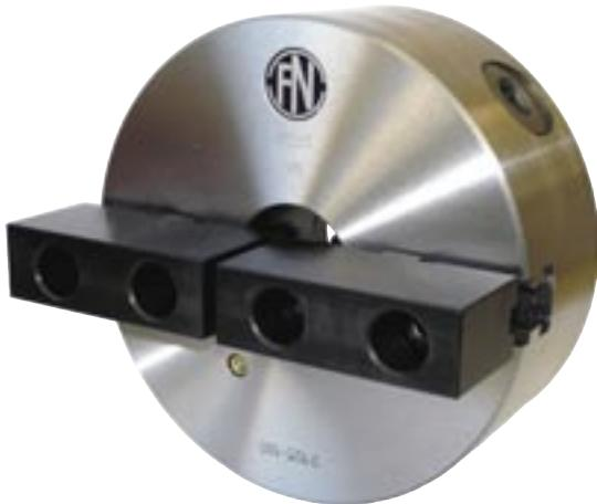
Les mâchoires de serrage s'ouvrent et se ferment, dans leur plage de serrage, de manière centrée et en continu, par le biais d'engrenages coniques (pignons) et de la spirale plane. Le corps du mandrin est en fonte et est équipé d'un système de lubrification central. Les garnitures sur la spirale plane et les mâchoires de serrage ont été trempées. Les flancs de la spirale et du filetage des mâchoires de serrage ont été rectifiés des deux côtés.
