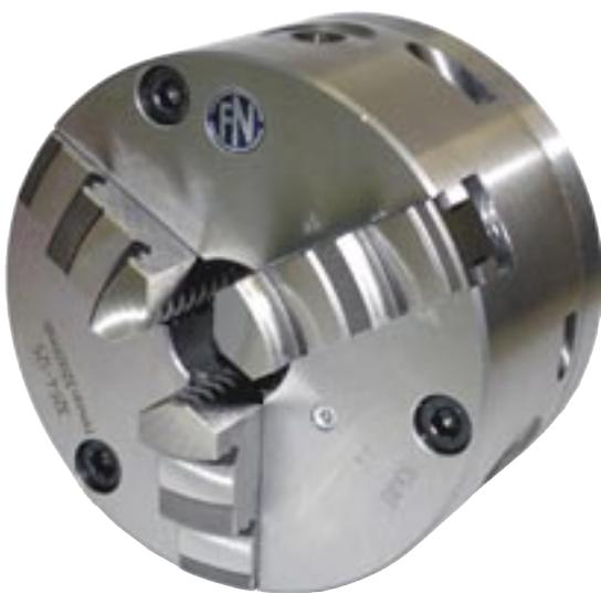
Réglage radial très fin conformément à la norme DIN 6350 avec mandrin ultraprecis en fonte et à serrage central. Les trois vis de réglage radiales permettent un réglage fin d'une précision inférieure à 0,005 mm et une reproductibilité de 0,015 mm. Les broches de réglage ont été trempées et les surfaces d'appui ont subi une trempe par induction.
