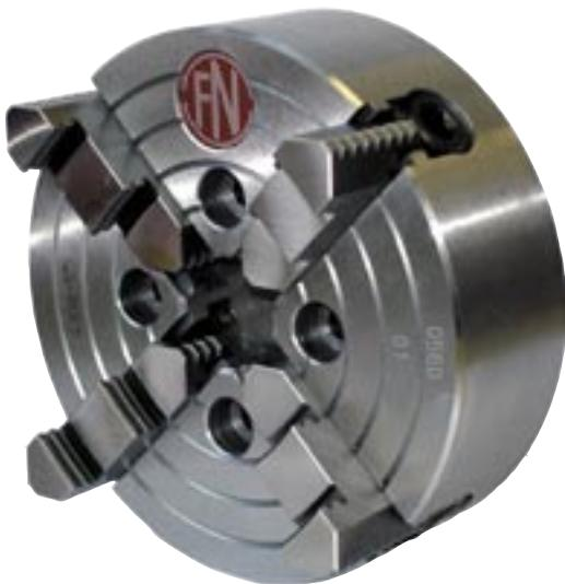
Plateaux circulaires avec corps en fonte ( $\varnothing$  150 - 160 en acier) et avec mâchoires de serrage réglables individuellement, monobloc et réversibles.
