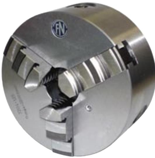
Les mâchoires de serrage s'ouvrent et se ferment, dans leur plage de serrage, de manière centrée et en continu, par le biais d'engrenages coniques (pignons) et de la spirale plane. Le corps du mandrin est en fonte et est équipé d'un système de lubrification central. Les garnitures sur la spirale plane et les mâchoires de serrage ont été trempées. Les flancs de la spirale et du filetage des mâchoires de serrage ont été rectifiés des deux côtés.
