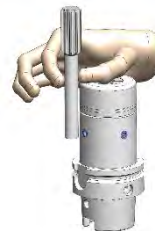
Image 2 – Déterminer la profondeur d'insertion
