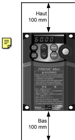
Figure 2-2-1 Sens de montage et distances nécessaires
