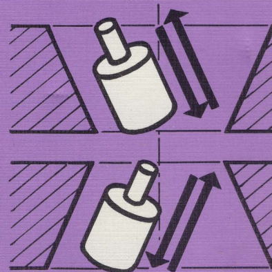
Rectification conique suivant la génératrice du cône.
