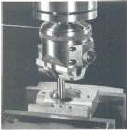
Réalisation d'une gorge de circlips.
