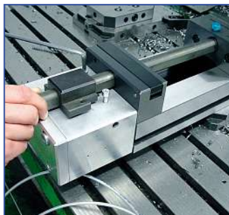
Schnelle Verstellung durch zurückziehen des Führungsstückes. Quick adjustment by pulling back the guiding slot
