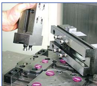
Mit Quick•Point in sekundenschnelle Umrüstarbeiten durchgeführt. With Quick•Point repositioned within seconds.
