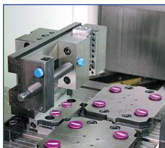
Stabile Spannung durch massive Stahlplatten. Solid clamping because of strong steel plates.
