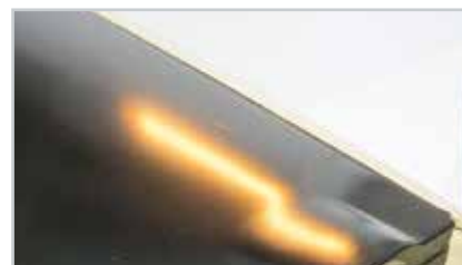
La polymérisation peut être accélérée grâce à la chaleur
