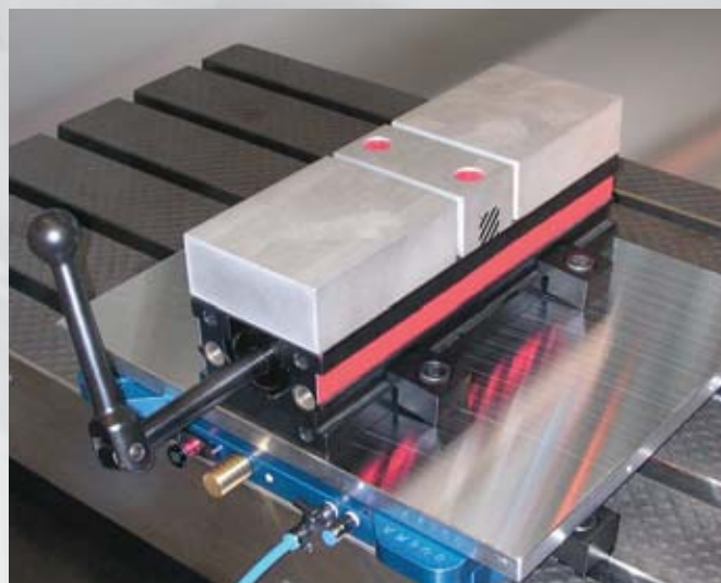
Étau monté sur palette standard, pour changement rapide.
