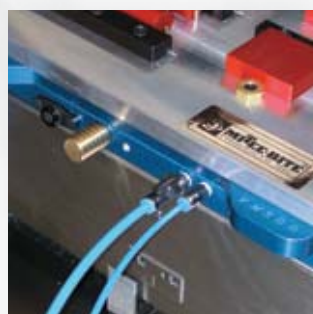
Le petit tube est relié à un commutateur de sécurité basse pression.
