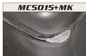
Usure de 0,44 mm Après usinage de 17 pièces
