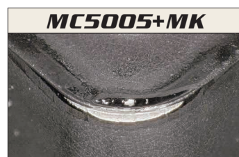
Usure de 0,29 mm Après usinage de 30 pièces
