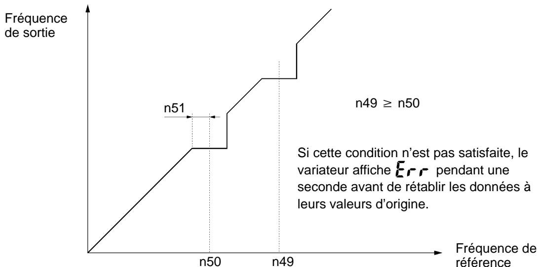
Son fonctionnement est interdit à l'intérieur du champ de saut des fréquences. Le moteur fonctionne toutefois sans "sauts" dans les phases d'accélération/décélération.
