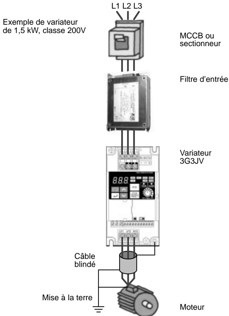
**Note:** Pour simplifier le schéma, le filtre d'entrée a été reporté en une position différente de sa position d'installation. Dans la réalité le filtre d'entrée est installé entre le variateur et le panneau de montage.
