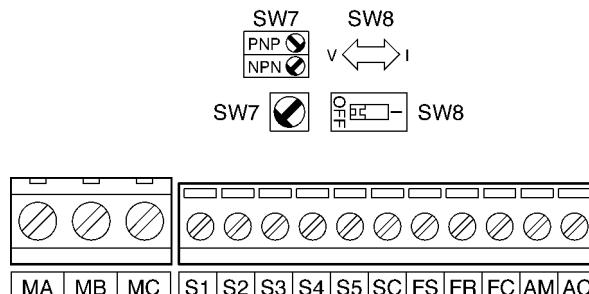
**Note:** SW7 peut être modifié en fonction de la polarité du signal d'entrée de la séquence (S1... S5)
