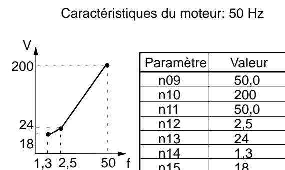
L'augmentation de la tension de la courbe V/f entraîne une augmentation du couple du moteur, mais une hausse excessive peut causer une surexcitation du moteur, une surchauffe du moteur ou bien des vibrations.
