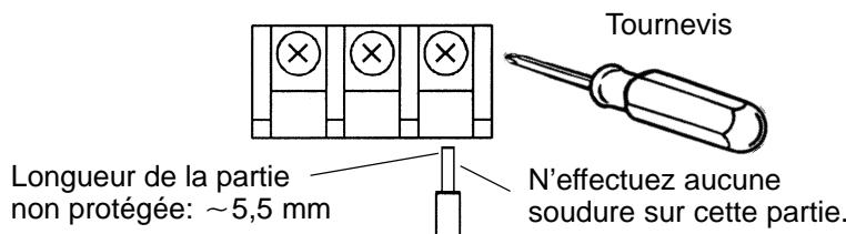
Effectuez la connexion en utilisant un tournevis cruciforme.
