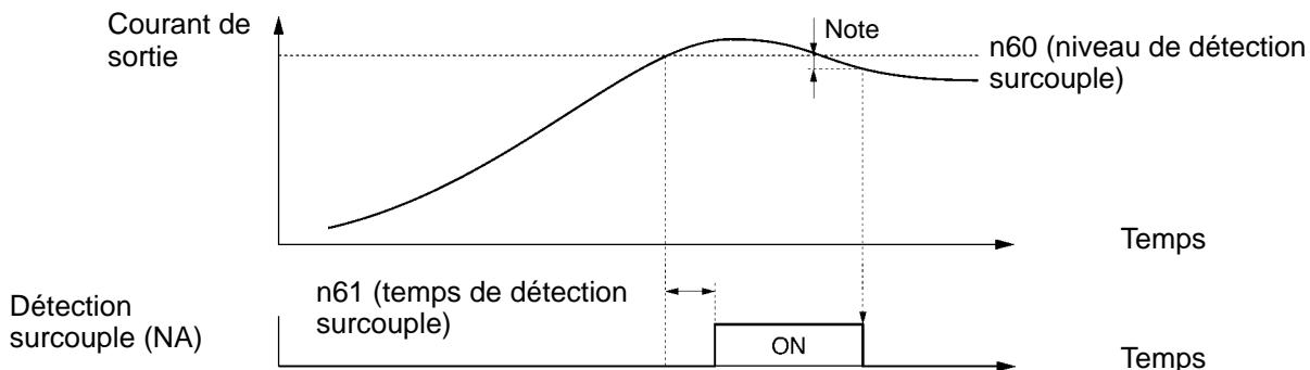
**Note:** La détection du surcouple sera annulée si le courant de sortie est inférieur à environ 5% du courant nominal du variateur de fréquence.
