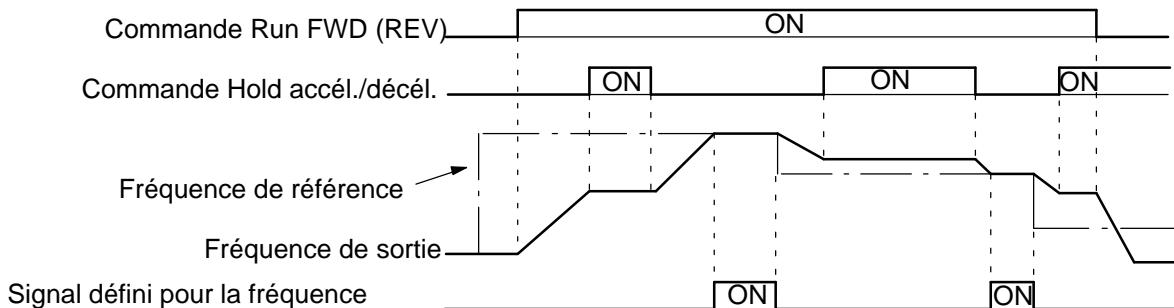
**Note:** Si la commande Run FWD (REV) est lancée en même temps que la commande Hold de l'accélération/décélération, le moteur ne tourne pas. Par contre, lorsque la limite inférieure de la fréquence de référence (n31) est réglée à une valeur supérieure ou égale à la fréquence de sortie minimum (n14), le moteur fonctionne à la valeur de la limite inférieure (n31).
