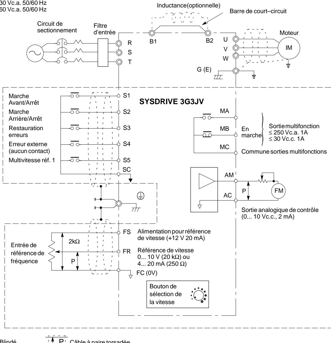
Pour les bornes du circuit de contrôle, il n'est prévu qu'une simple isolation de base. Pour le produit final, il peut être nécessaire de prévoir une isolation supplémentaire.
