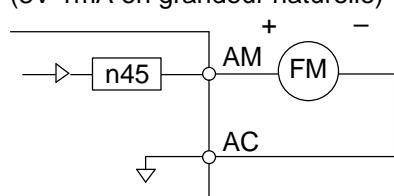
Fréquence de sortie (courant de sortie)
