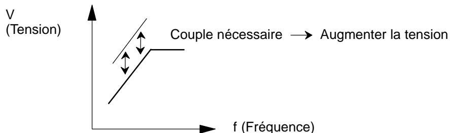
Généralement, aucun réglage n'est requis pour le gain de la compensation de couple (valeur d'usine du paramètre n63= 1,0). Lorsque la distance de câblage entre le variateur et le moteur est élevée ou le moteur émet des vibrations, modifiez le gain de la compensation de couple. Dans ces cas-ci, réglez la courbe V/f (n09... n15).
