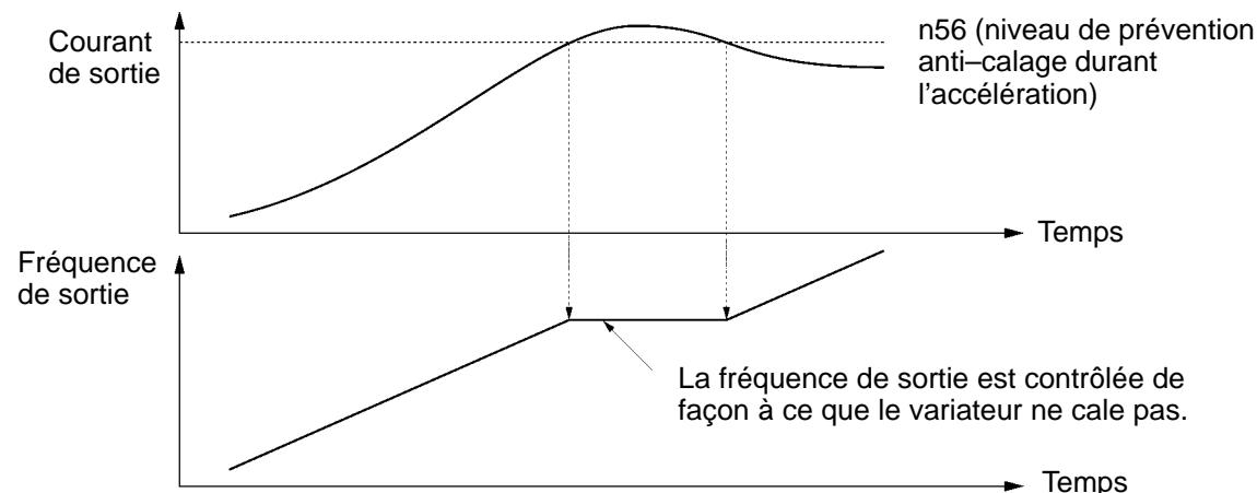
Dans la zone de sortie du paramètre (fréquence de sortie > fréquence maximum tension de sortie (n11)), l'équation suivante diminue automatiquement le niveau de prévention anti-calage (limite courant) durant l'accélération.
