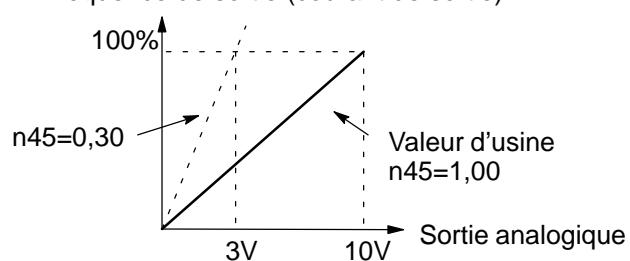
Cette fonction permet de régler la tension de sortie à 100% de la fréquence de sortie (courant de sortie). A 0... 3V, le fréquencemètre a un champ d'affichage de 0 à 60 Hz.
