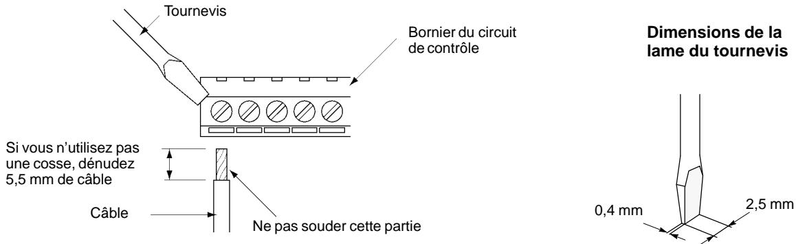
Introduisez le câble dans la partie inférieure du bornier et serrez-le fermement à l'aide d'un tournevis.
