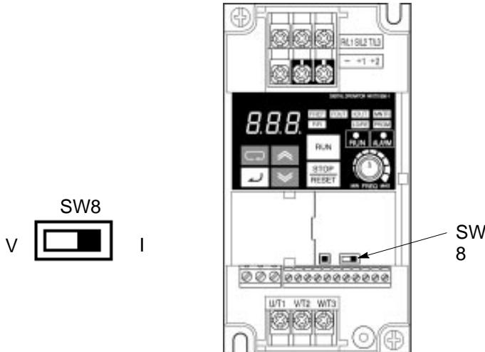
**Note:** Ne jamais envoyer la tension de référence à la borne FR du circuit de contrôle lorsque le micro-interrupteur SW8 est positionné sur "I".
