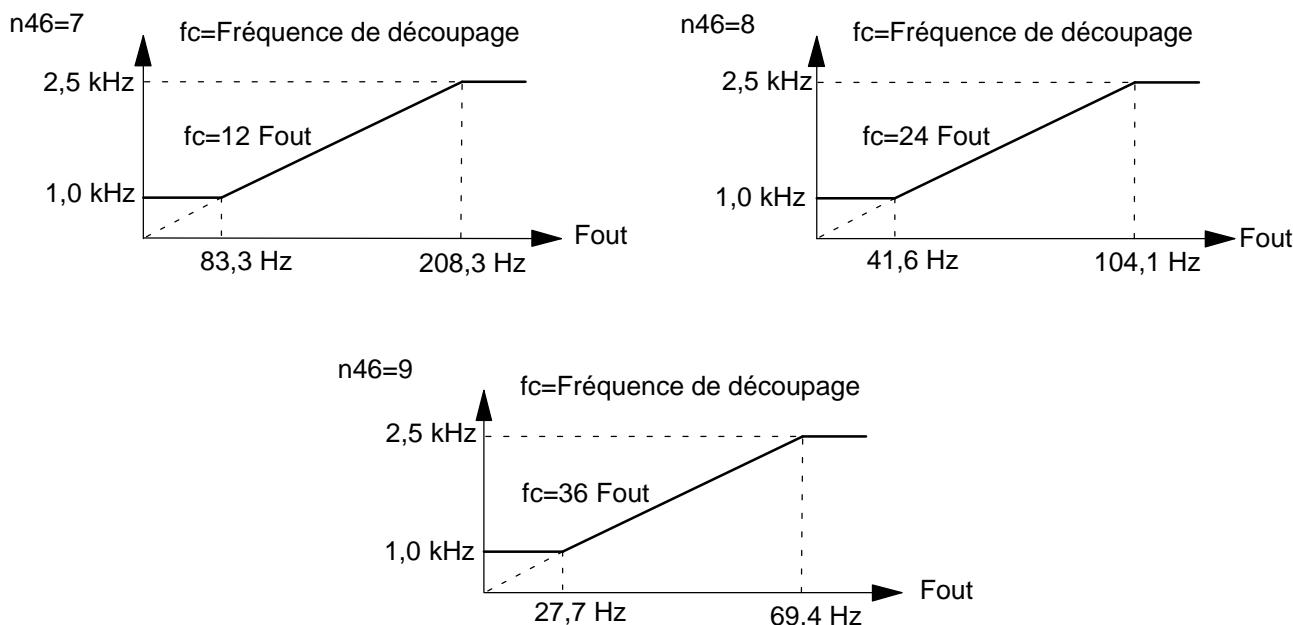
Les configurations varient en fonction de la puissance du variateur (kVA).
