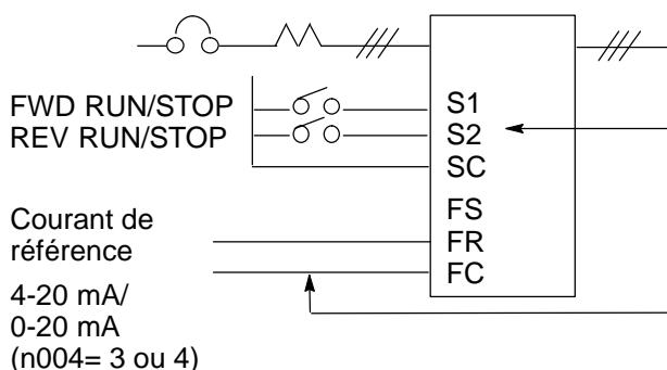
Commutez entre Run et Stop et Run FWD/REV en utilisant le dispositif de commutation connecté à la borne du circuit de contrôle.
