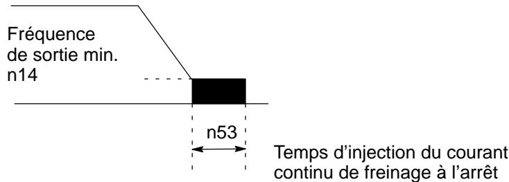
Lorsque la modalité d'arrêt (n04) sélectionnée est l'arrêt par inertie, l'injection de courant continu de freinage n'est pas appliquée.
