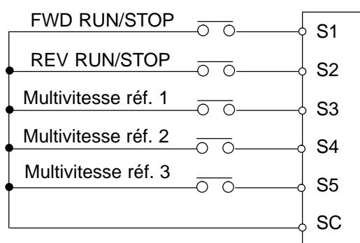
**Note:** Lorsque toutes les entrées multifonction de référence sont DESACTIVEES, la fréquence de référence sélectionnée avec le paramètre n03 (sélection de la fréquence de référence) devient opérationnelle.
