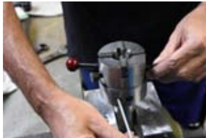
5. Lösen der Gegenschraube zur Gewinde-Feineinstellung
