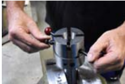
2. Zurückziehen der Schließkurve mittels Auszieher
