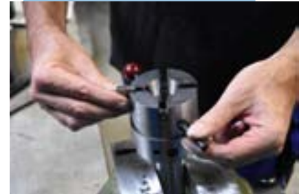
3. Einsetzen und Auswechseln der Gewindeschneidbacken entsprechend der Numerierung
