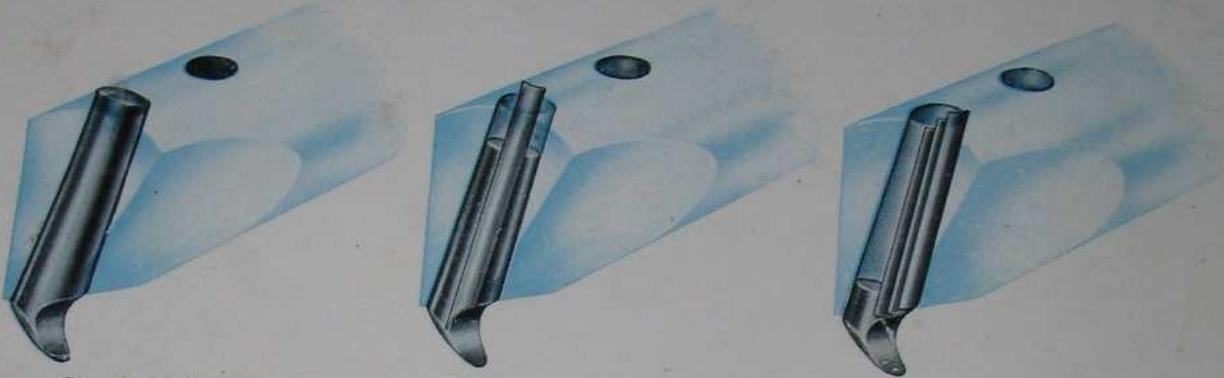
Durch Einlegen einer oder mehrerer aufeinander gelegter Lamellen können die Einsätze etappenweise nachgestellt und bis auf einen kleinen Rest ausgenützt werden. Die Lage der Lamellen in der Schaftbohrung kann beliebig sein, doch sollen diese den Stahl bis vorne abstützen.
