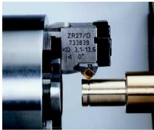
Tête ZR 27 avec plaquette de rainurage
