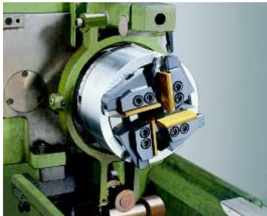
Tête Z 39 sur machine à fileter
