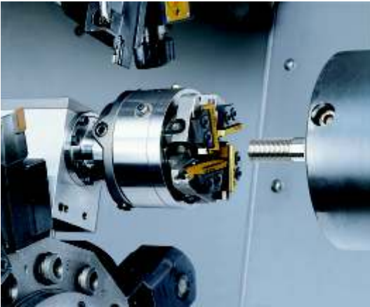
Tête ZA 22 sur tour CNC avec révolver étoile
