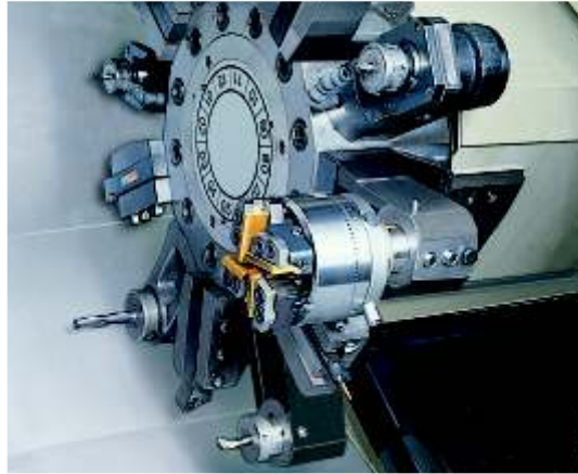
Tête ZA 22 sur tour CNC avec révolver disque
