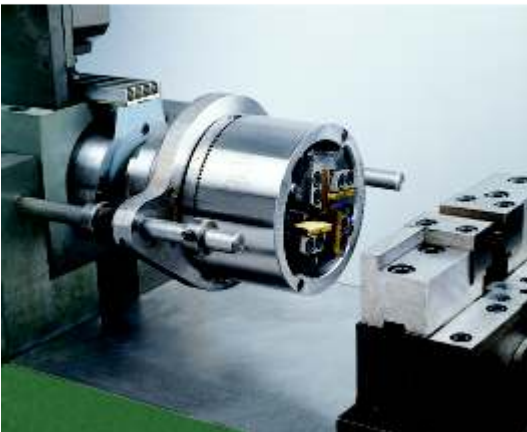
Tête Z 27 GK sur machine spéciale avec unité de broche
