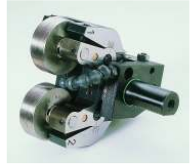
Dispositif de roulage tangential
