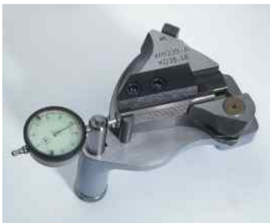
Réglage du peigne dans le porte-peigne avec l'aide du dispositif de réglage des peignes
