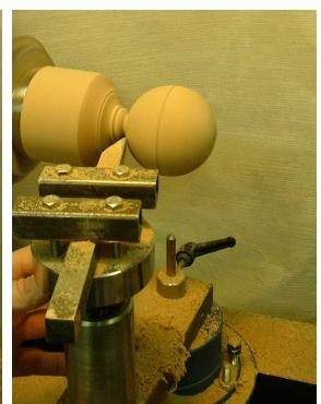
Système de mise en place et de blocage rapide. Une traverse est solidaire, par l'intermédiaire d'un axe, d'un excentrique de selle de vélo. Tout d'abord la traverse est parallèle au banc du tour, on met en place la sphéreuse. On tourne de  $90^\circ$  l'excentrique : la traverse se met en travers du banc. On abaisse l'excentrique : la traverse remonte et se bloque contre le banc, la sphéreuse est ainsi immobilisée.
